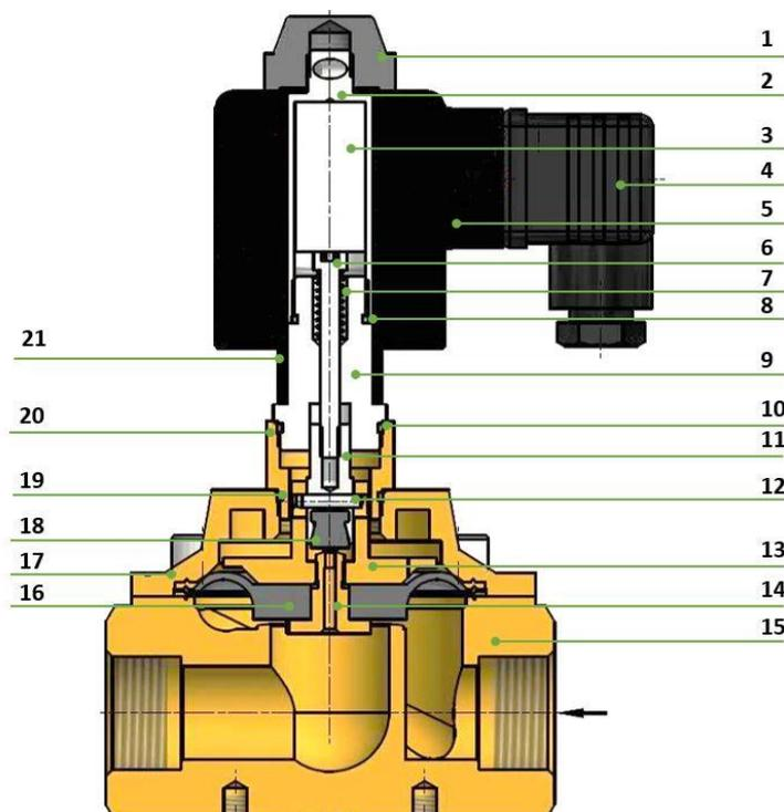
**Magnetventil, stromlos offen, zwangsgesteuert, Wechselstrom**
